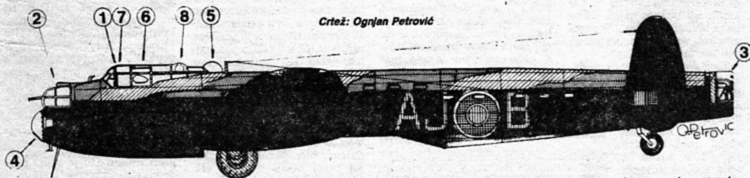
Slika br. 1: „Razbijač brana“ sa Valisovom bombom pod trupom i rasporedom posade
