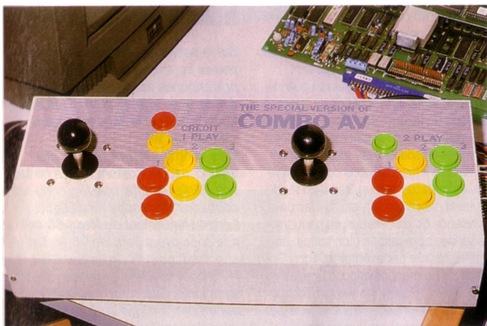
Destinée initialement au marché japonais, la Combo AV lit le standard Jamma.
