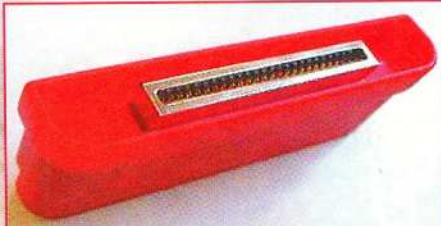
Die einfachste Form eines NTSC-Adapters: Eine verlängerte Schnittstelle (Preis: ca. 30 Mark) umgeht die Schachtsperren des Nintendo 64.
