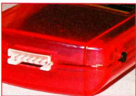
Erst wenn die Nexus-Card im Pad eines angeschalteten Dreamcasts steckt, ist die Schnittstelle zum PC aktiv.
