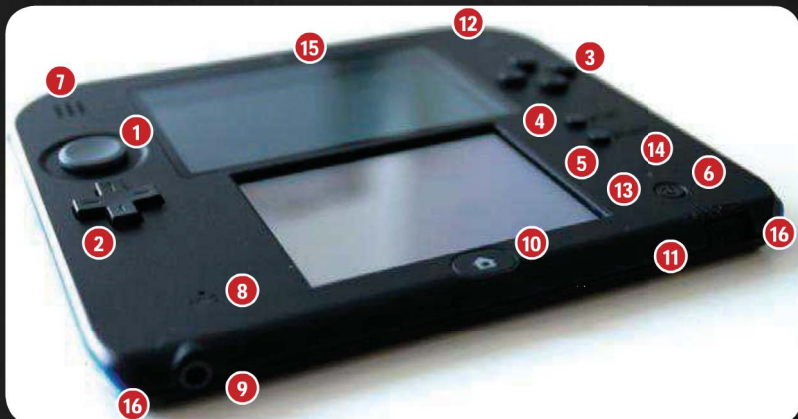
1.滑杆、2.十字键、3.A/B/X/Y键、4.START键、5.SELECT键、6.电源键、7.扬声器、8.麦克风、9.耳机插口、10.HOME键、11.休眠开关、12.擦身通信灯、13.电源灯、14.充电指示灯、15.摄像头、16.挂绳口
