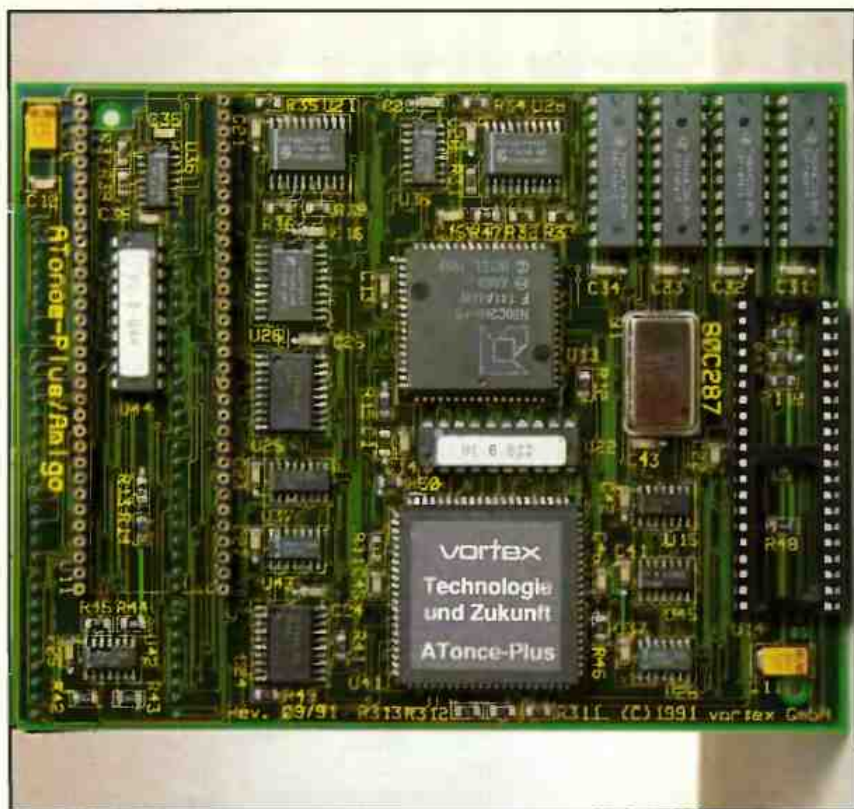
La placa lleva un procesador 286 a 16 Mhz y un zócalo para insertar un coprocesador aritmético.
