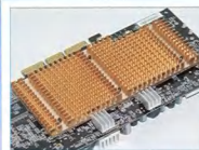
正面的兩組 4000rpm 散熱風扇，加上背後一大片的銅製散熱片，讓這張 Volari Duo V8 Ultra 就格外的有「份量」。
