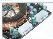
兩個 GPU 吃電也是不小，使用者必須外接兩組大 4-pin 電源接頭，用來供電給兩顆 Volari Duo V8 Ultra。
