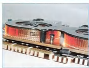
正面的兩組 4000rpm 散熱風扇，加上背後一大片的銅製散熱片，讓這張 Volari Duo V8 Ultra 就格外的有「份量」。
