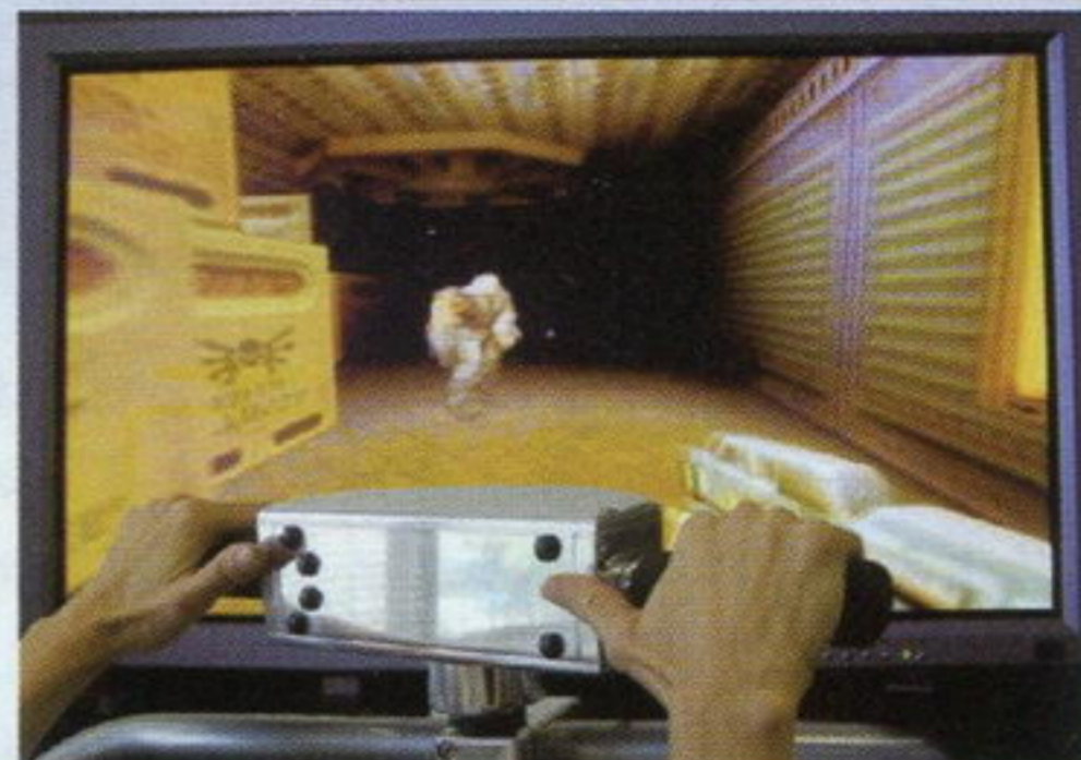
▲这款设备叫做 FPGamerunner，是为 FPS 玩家设计的移动控制器，由跑步机改造而来。通过转动车把部分以控制转向，拇指所在部位设计有多个按键，可以用来移动镜头和射击。
