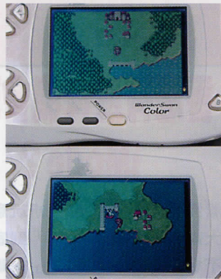
◆上方的畫面是 CONTRAST「LOW」，下方的則是 CONTRAST「HIGH」，很明顯「HIGH」的顏色比較鮮艷
