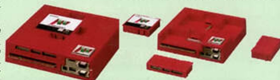
▲ATOMISWAVE 主基板是可以分拆的，最上面那块就是游戏卡带。
