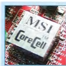
848P Neo主機板內建了微星科技獨創的CoreCell 核芯處理器晶片
