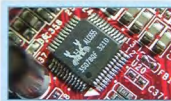
音效與網路均採用同一家公司的產品，音效則是 AL655 六聲道 AC97 Codec。
