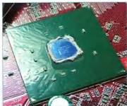
Intel 82848P，由於表面的散熱膏太黏，搞半天我放棄，所以就讓散熱膏在上面吧！
