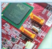
微星 848P NEO 提供兩組 Serial ATA 150 接頭。
