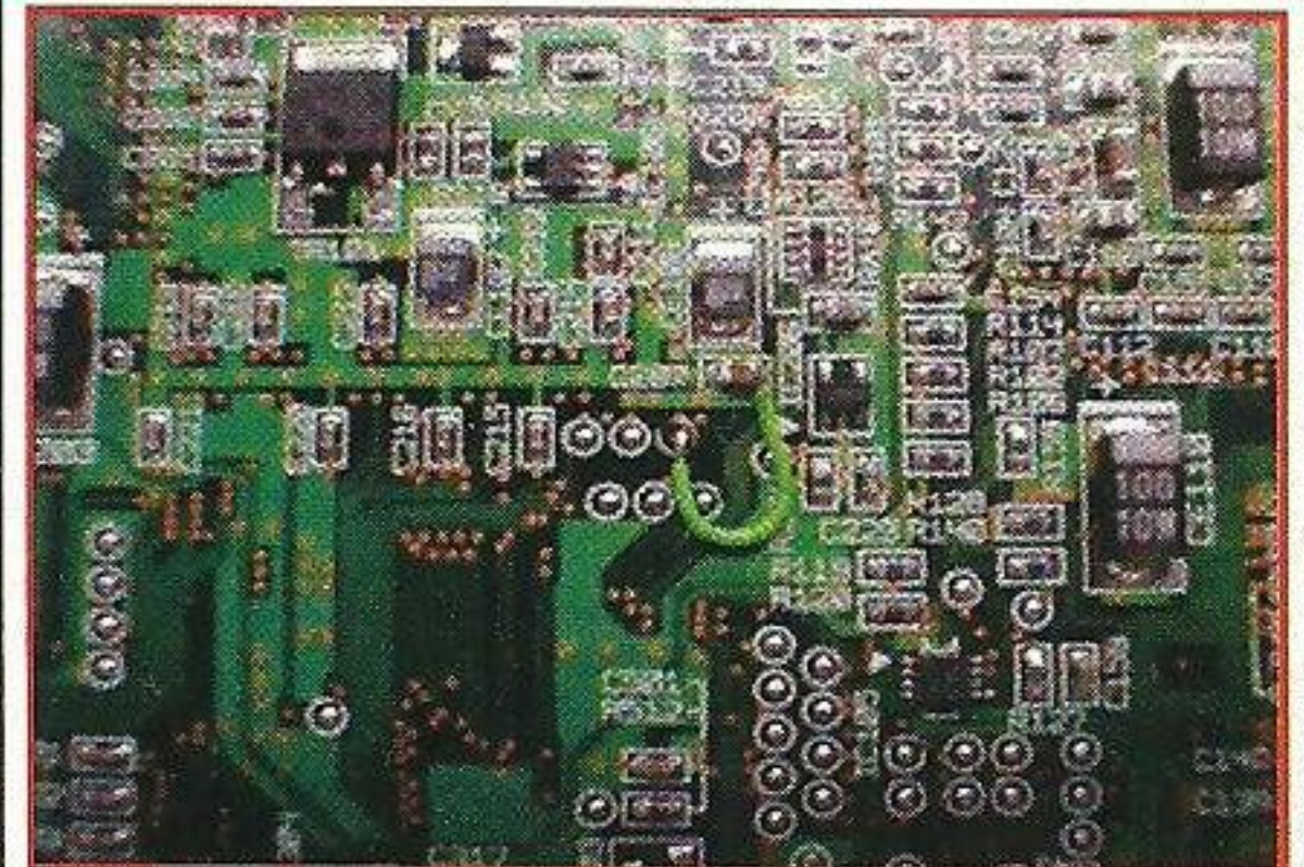
3. Na płycie głównej japońskie chłopaki wylukali kabelek lutowany -dosłownie- w ostatniej chwili przed premierą. Chyba w przyszłości Sega zastąpi to ścieżką na płycie?
