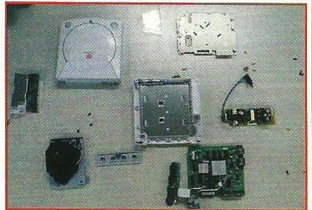
1. Dece w kawałkach. Widać tu wszystko - obudowę, mainboard, zasilacz, GD-Rom i modem.
