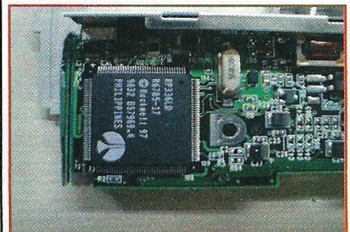
5. Modem działa w oparciu o kość Rockwell. To znaczy, że ma homologację w Polsce.
