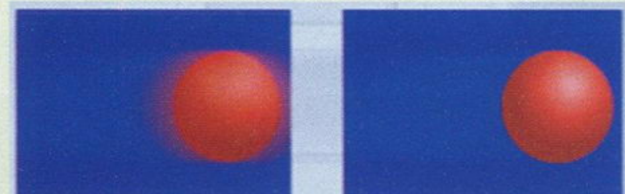
▲动态补偿示意图，左边是未使用动态补偿，右边是使用动态补偿。
