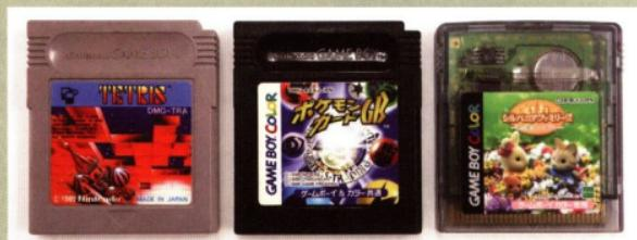
▲左から「モノクロ専用」、「モノクロ／カラー両対応」、「カラー専用」カートリッジ。
