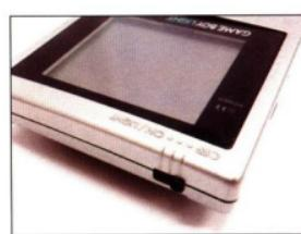
▲電源スイッチは3点式となり、バックライトのON/OFFも電源スイッチが兼ねている。
