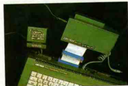
Conexión (con el alimentador) a un 6128
