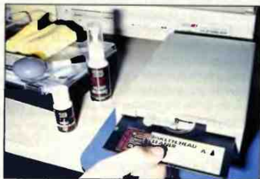
El disco-limpiador se rocía con la solución no abrasiva que permite limpiar las cabezas sin desgastarlas.
