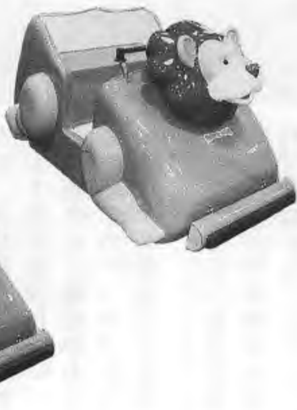
森のどうぶつたち ライオン 電磁誘導によるバッテリーカー。埋め込まれたケーブルから発する電磁波をキャッチしながら走行する。OP価格175万5千円。【朝日エンジニアリング】No.443
