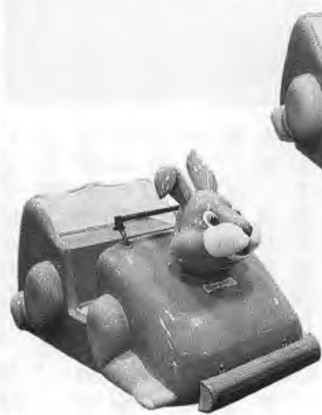
森のどうぶつたち ウサギ 電磁誘導によるバッテリーカー。ゴルフ場での移動カートを乗物機に転用。決められた軌道上を走行。OP価格175万5千円。【朝日エンジニアリング】No.443
