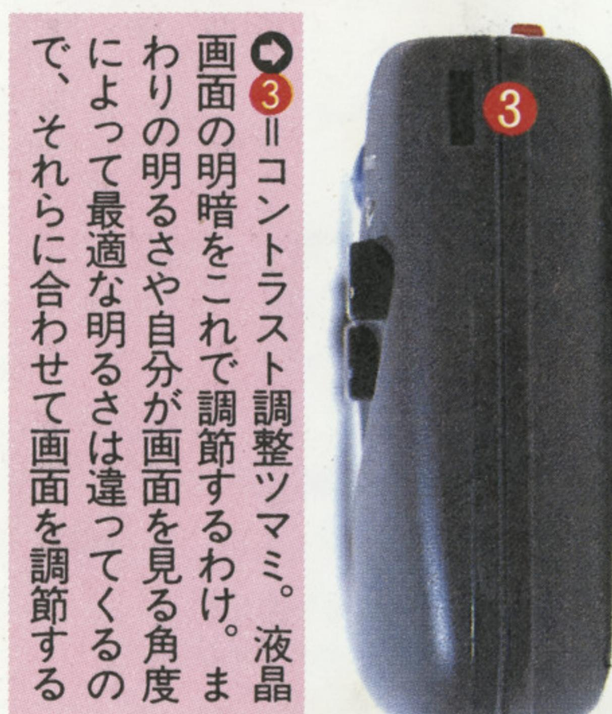
③=コントラスト調整ツマミ。液晶画面の明るさや自分が画面を見る角度によって最適な明るさは違ってくるので、それらに合わせて画面を調節する
