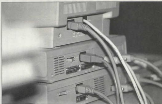
Conexiones de la impresora láser a un Mega ST4 con disco duro
