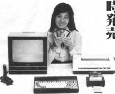
東芝ホームコンピュータ「パソピアIQ」 奥(左)モニタテレビ (右)プリンタ (手中)ROMカートリッジ 手前(左)ジョイスティック (中)本体 (右)増設用スロット
