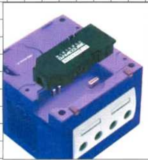
Ein 56k V.90 Modem sorgt für gute Anbindung an das Internet.
