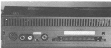
リア部/左からカセットポート、ビデオ・オーディオ端子、チャンネルスイッチ、RF端子、拡張バスコネクタ
