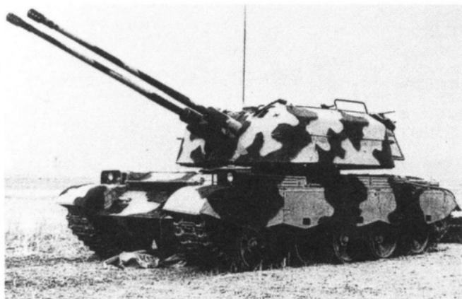
中国にごく最近配備された最新型の対空自走砲だ。中国製の69式主力戦車の車体に、ソ連の対空車両をモデルにして開発された砲塔が搭載されている。
