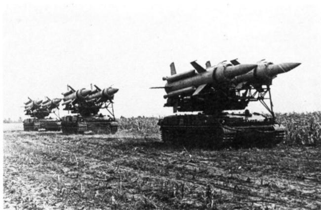
中低空防空用の地対空ミサイルを装軌車両に搭載した対空ミサイル車両だ。1964年のモスクワパレードで、その存在が確認された。通常は、第一線の後方10~20キロメートルにレーダー車、ZSU-23-4シルカとともに位置して、中低空の防空任務に使用されている。
