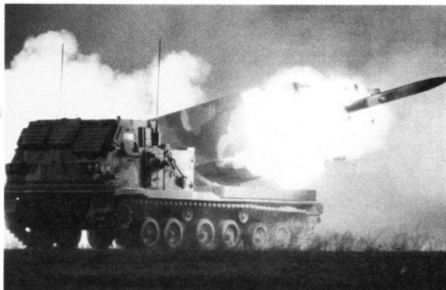
1979年に試作され、1981年に量産が決定されたアメリカの多連装ロケットランチャー。C-141輸送機による空輸も可能で、車体前部に乗員3名が乗車する。MLRSは、短時間に大量の弾を発射することを主目的として、M978輸送車(M2ブラッドレイと同一車体)とロケットランチャーから開発されたのだ。
