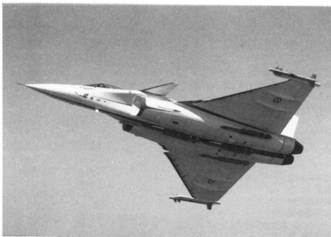
ラファールは高機動性、戦闘時における大仰角での飛行維持、STOL性の向上などに重点がおかれてダッソー社によって開発された。その結果、カナード翼つきデルタ翼という独特の形状になったわけだ。しかもフランス軍の、「より小型で軽量の機体」という欲求を満
