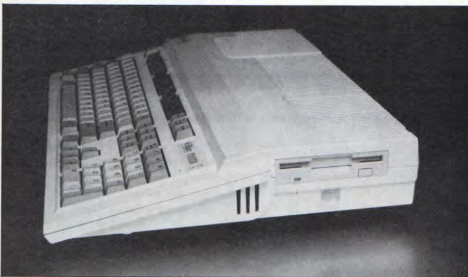
Η αριστερή πλευρά του A3000. Το πολύ λεπτό αλλά ισχυρό drive βρίσκεται εδώ. Ακριβώς από κάτω υπάρχει ένα μικρό τετράγωνο πλαίσιο. Είναι το reset.
