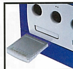
La Digicard a quatre mégabits de mémoire flash. Notez qu'on ne trouve que deux ports de branchement.
