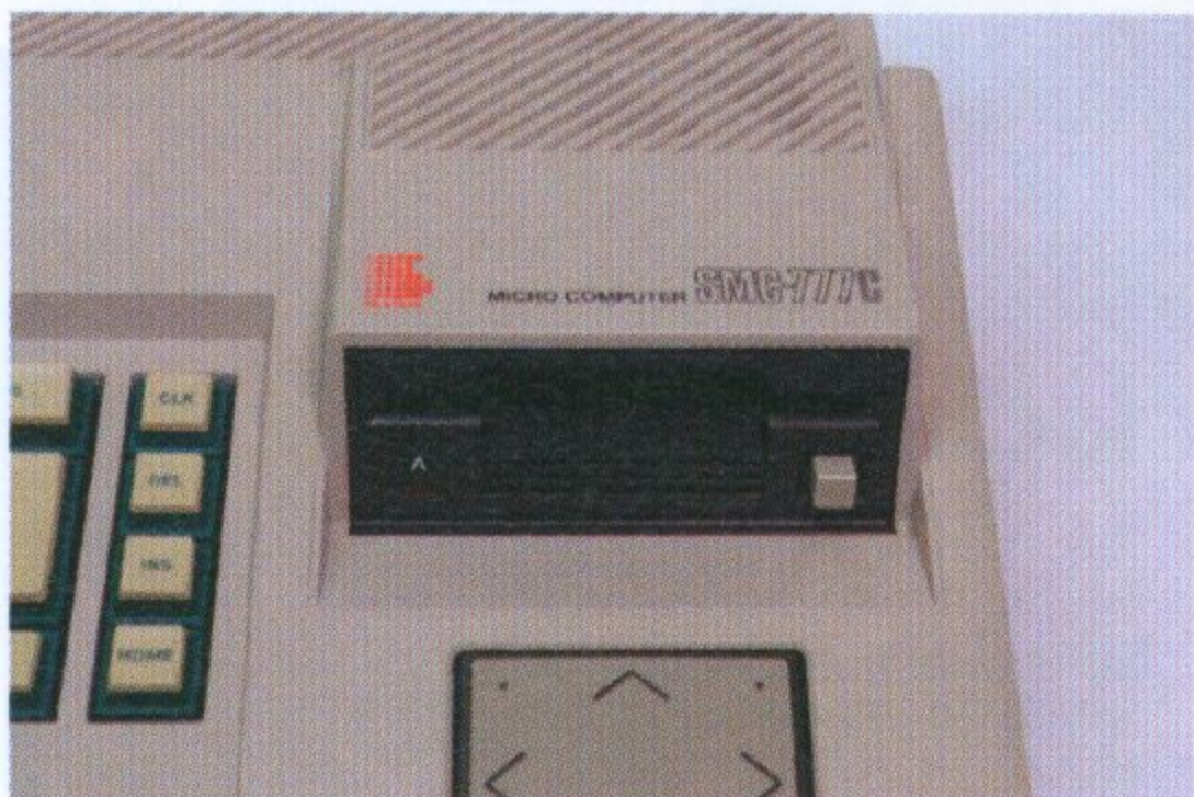
▲本体右側に設けられた3.5インチ1DDのディスクドライブ。SMC-777は初のディスクドライブ標準搭載となった。
