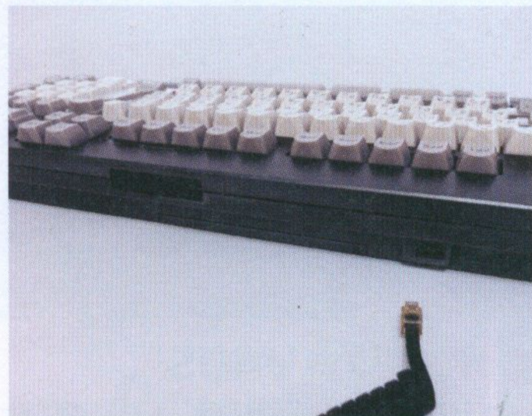
▲キーボードは赤外線によるワイヤレス接続。ケーブル接続するためのモジュラー端子も備えている。
