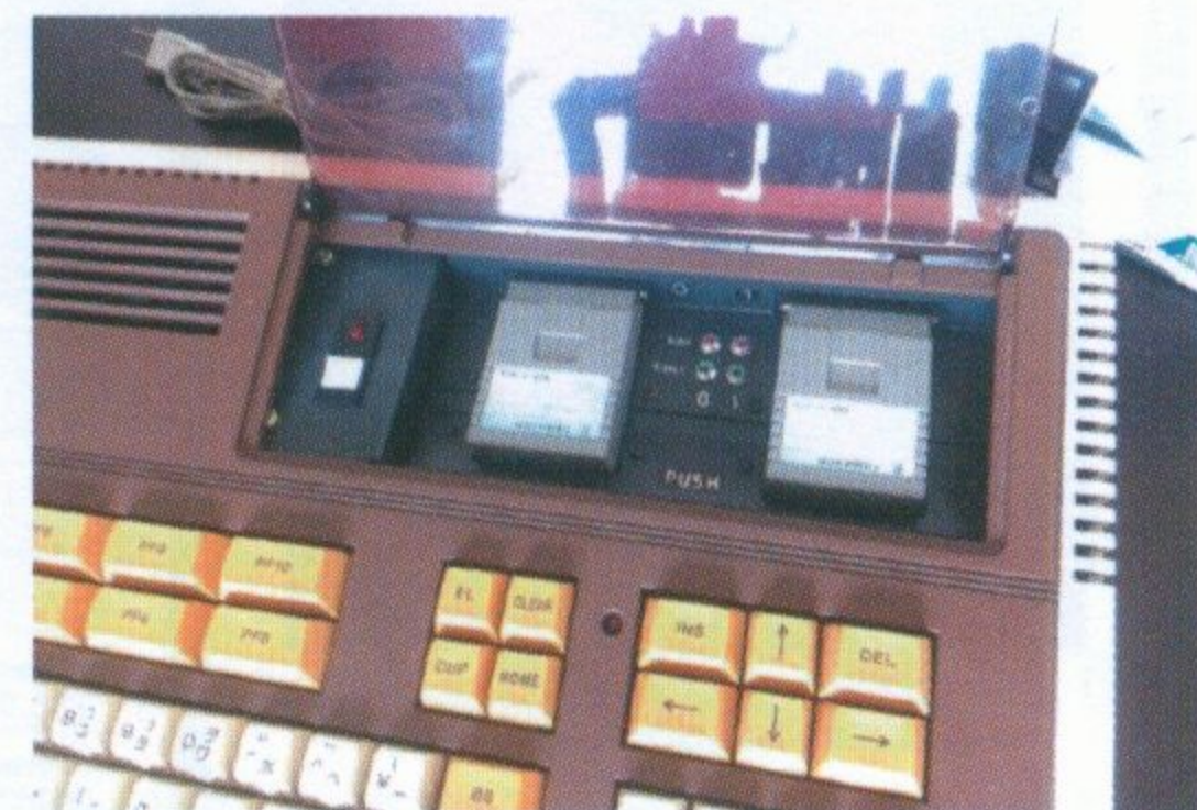
▲右上のソケットに装着された、2個のバブルメモリ。当時の富士通はこれを記録媒体の本命として推していた。
