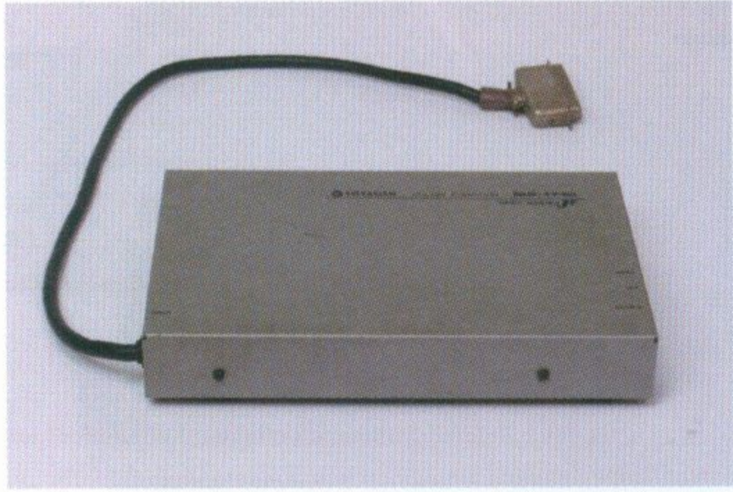
▲ベーシックマスターJr. 専用の周辺機器、カラーアダプター。背面の拡張ポートに接続する。
