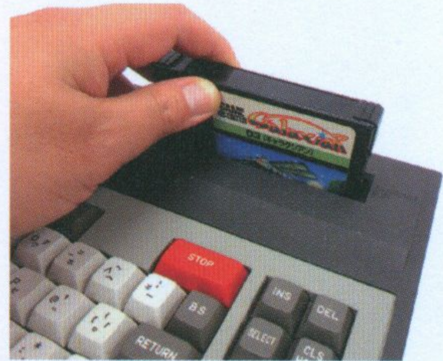
▲本体に設けられたカートリッジスロット。大抵複数スロット存在した。
