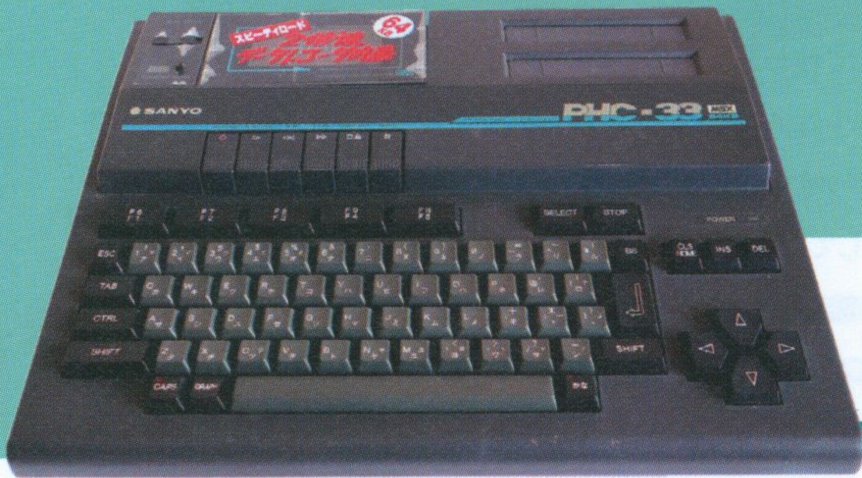
PHC-33 三洋電機特機 1986年10月発売 59,800円 倍速データレコーダーを内蔵したユニークな機構。データレコーダーを搭載しない兄弟機、PHC-27も存在する。
