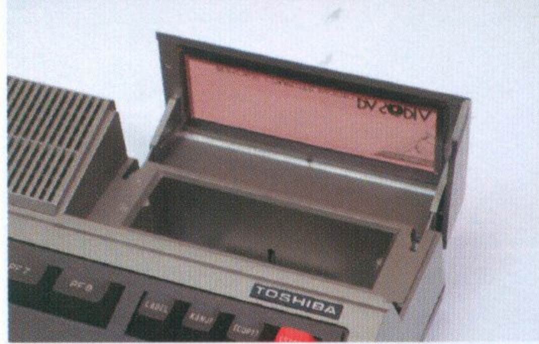
▲右上の透明プラパーツのある箇所はPAC装着用スロット。ここに2個のPACを装着できる。
