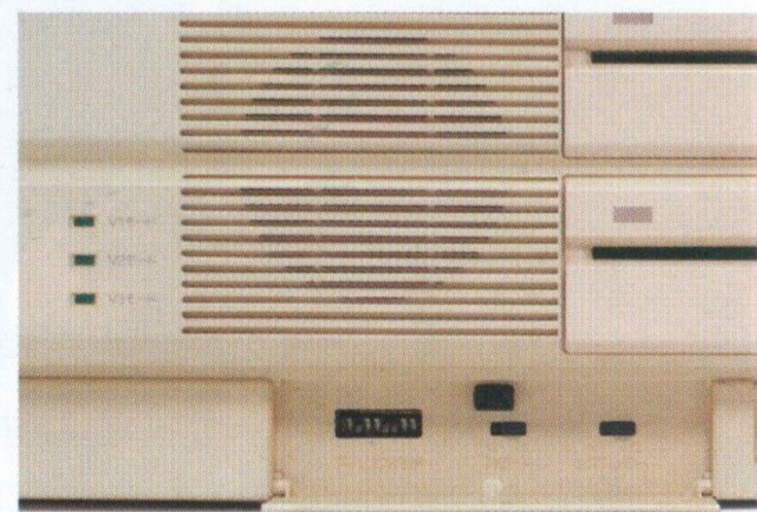
▲PC-8801VA2の正面フロントパネル。各種モード切替スイッチのほか、V3モードのLEDが追加された。
