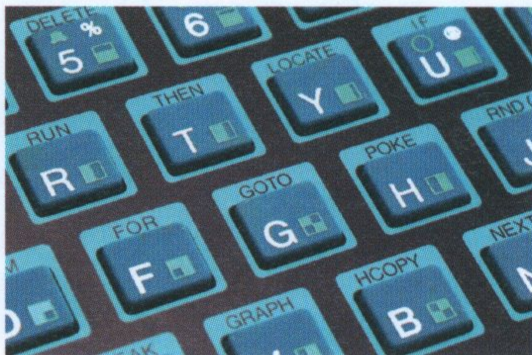
▲キーボードにはよく使用されるBASICコマンドが印刷されており、CTRLキーと同時押しでワンタッチ入力が可能。
