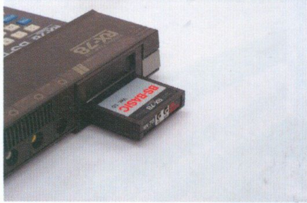
▲背面のカートリッジスロット。2つ備えており、ソフトの供給以外にも拡張端子として活用できる。
