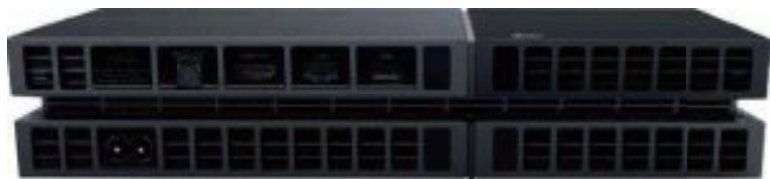
◀由复数的方格组合而成是PS4的特色设计之一。背部也是这种风格，各种端子接口、吸气排气口都体现出设计的统一性。
