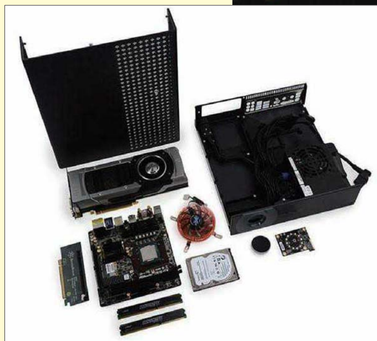
▲著名拆解网站 iFixit 的 Steam Machines 拆解图，可以看到除了本体的散热风扇，还有显卡的风扇和电源的风扇用于排出热量。
