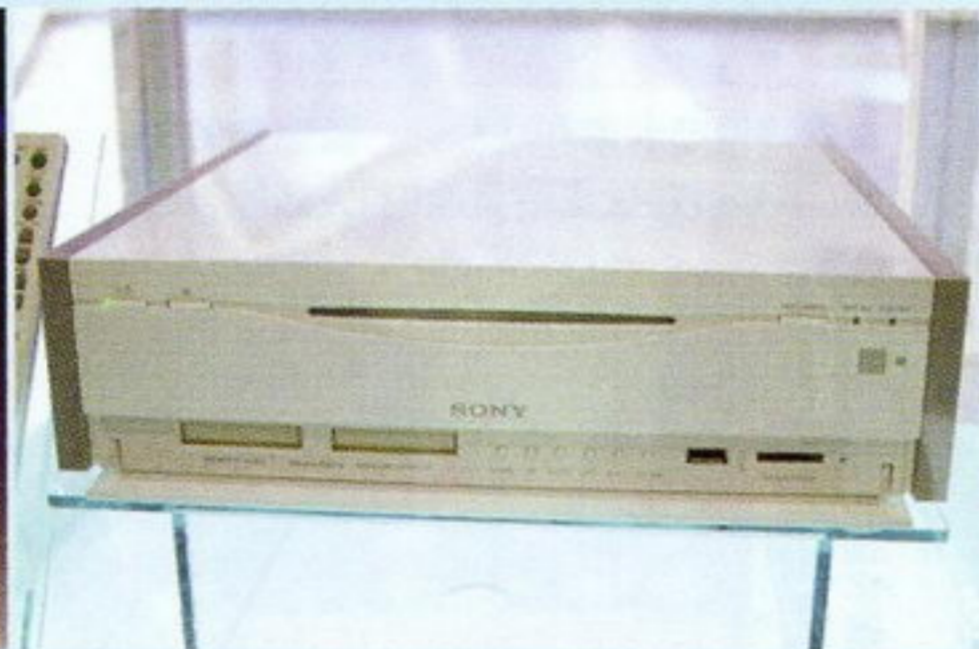
▲打开主机正面上方的盖子,就可以看到记忆卡插口及USB插口了,这里还有一些常用的功能键。
