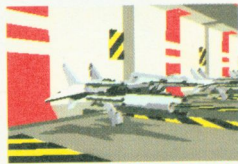
▲パレット式格納システムの格納庫の中で、パレットに載って格納状態の同機。
