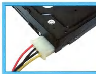
如果沒有 SATA 電源線，也可以使用一般的 D 型 5V 電源接頭供電。
