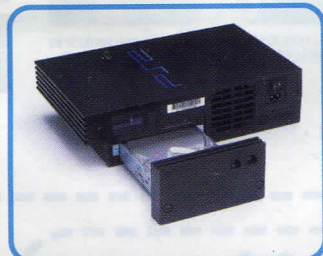
NETWORK ADAPTER同時是固定硬碟機的裝置
