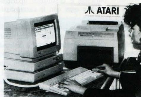
Il risultato è una stampa di alta qualità con una risoluzione di 300 punti per pollice. In 1 mm<sup>2</sup>, ad esempio sono contenuti 140 punti.
