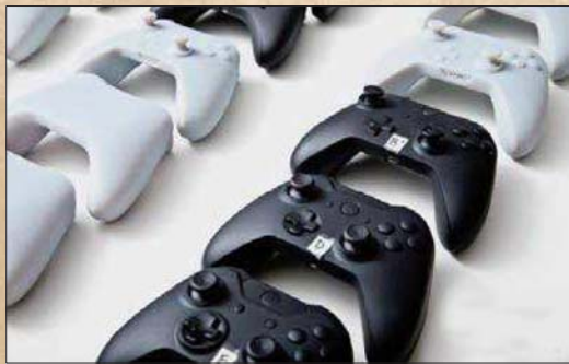
▲通过 3D 打印机制作出无数个手柄原形。
