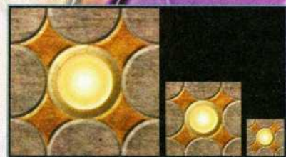
Fürs Mip Mapping werden verschieden große Texturvarianten benötigt
