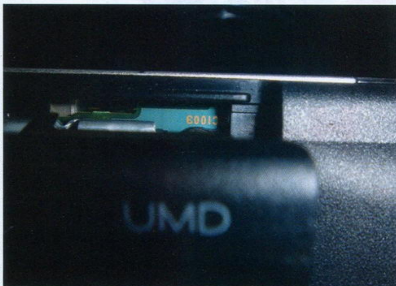
▲UMD仓盖后电路板上标有IC1003是TA-82主板的特征。
