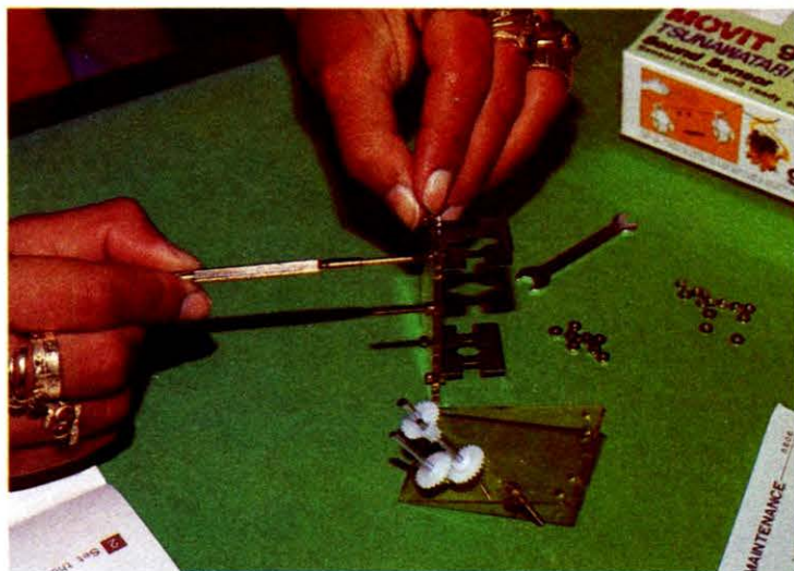
2 - La prima fase del montaggio consiste nell'assemblare il «corpo» del robot: in primo piano gli ingranaggi che trasmettono il movimento alle braccia meccaniche.
