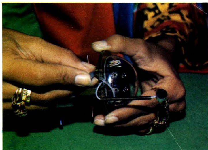
7 - L'elettronica è stata fissata, così come il sostegno elastico della capsula microfonica e la cupoletta trasparente che ricopre la «testa» di Monkey.
