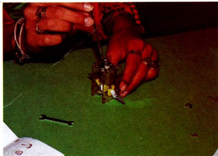
4 - Posizionato correttamente il motorino non rimane che fissarlo saldamente con le apposite viti fornite nel kit.
