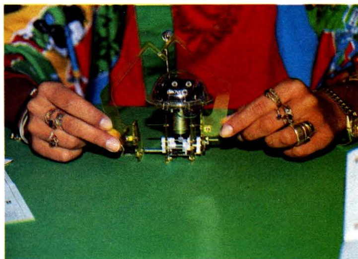
8 - Ultima fase di montaggio: si posizionano gli «arti prensili» precedentemente preassemblati, non rimane che fissarli adeguatamente.
