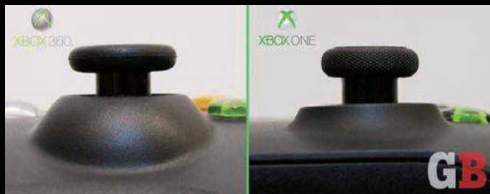
▲ 由于摇杆底部突出部位较小，Xbox One摇杆感觉更高一些，实际高度是相同的。
