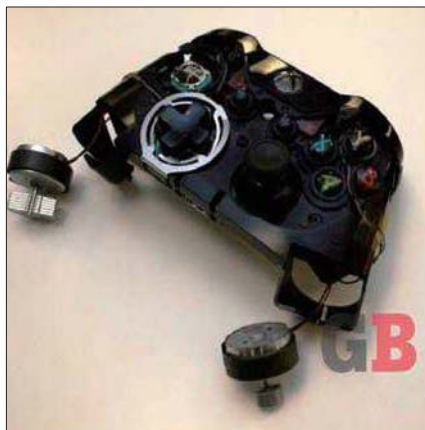
▲Xbox One手柄的内部，两个振动马达裸露在外。
