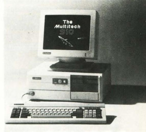
Il 910 può essere dotato di diversi tipi di adattatori per il collegamento di monitor: oltre alle schede EGA (enhanced graphic adapter), CGA (color graphic adapter), e MGA compatibile con la grafica monocromatica Hercules, è possibile utilizzare una scheda multi-display che include la compatibilità con MD, CGA, MGA, le funzioni Plantronics Colorplus e l'interfaccia per penna ottica.
