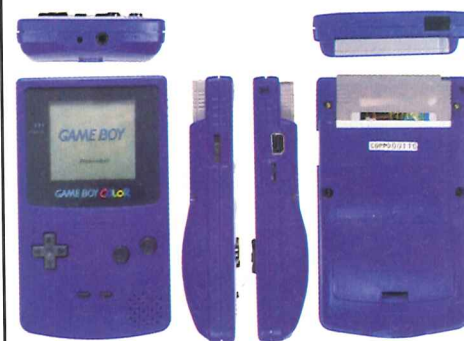
■ Las mejoras de la Game Boy Color incluyen puerto de infrarrojos y un hueco para las pilas.
