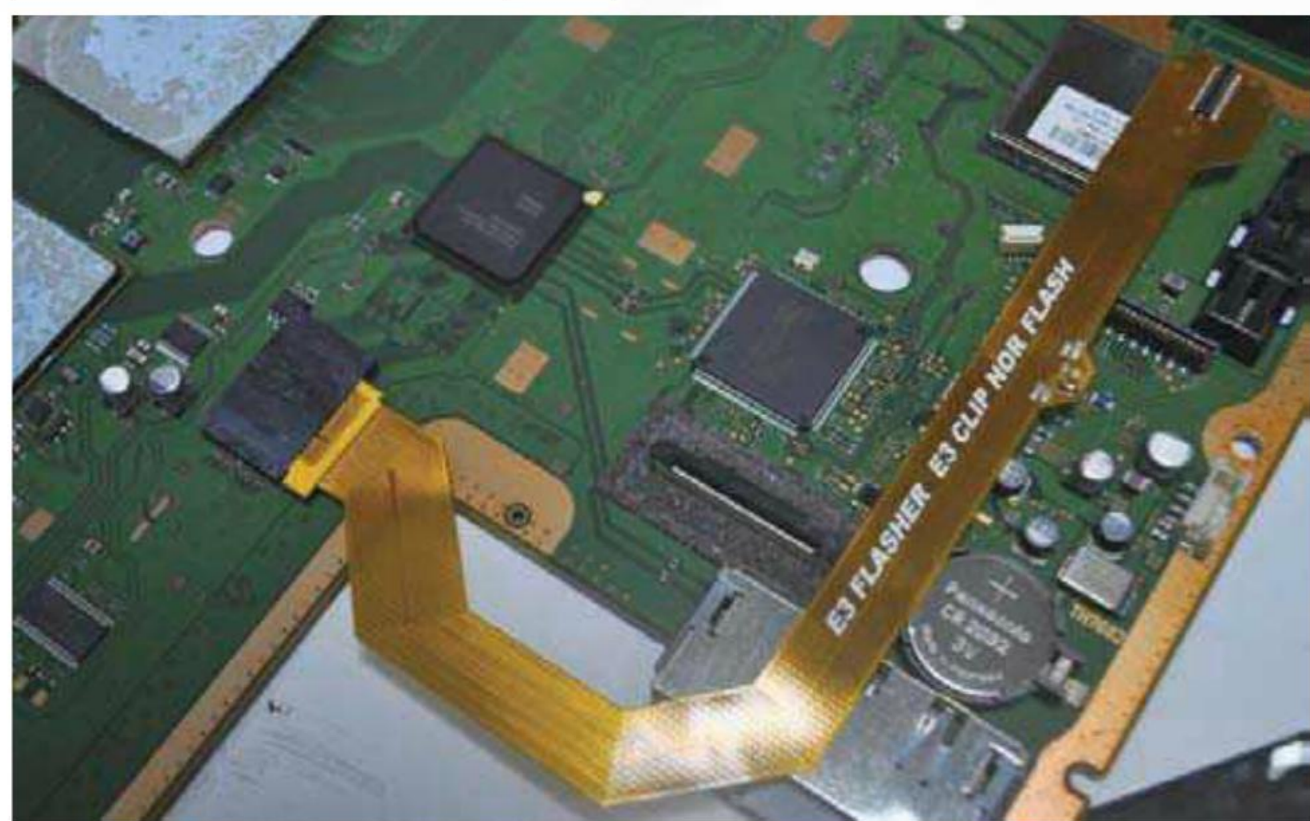
▲硬破解主机需要拆机安装E3 Flasher，况且主机也大多是回收来的，质量上确实难以保障。
