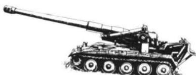
M109とならんでアメリカの砲兵の中心がこのM110である。M107同様、砲塔はなく直接車体に砲身がマウントされている。砲は生産時期によりA1型、A2型、E1型、M115型、M241E1型などが存在している。この兵器の特徴としては、他の砲の都市攻撃率が5%なのに対して、この砲は10%の攻撃率を持っている上、破壊力が3もあるため、都市のレベルを下げるには役立つ車両である。しかし反撃射撃があるので、当然損害を受けるのも覚悟せねばならない。
