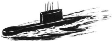
2000年に退役が予定されている205級潜水艦の後継として開発が進んでいる艦で、ノルウェーが使用している210級潜水艦のシステムを継承し、20人程度で操作が行えるよう、徹底的に自動化を推進した艦である。武装は対水上艦用のもののみで、対潜水艦装備は持っていない。作戦海域を北海としているため、高速航行性は持たなくともよく、じっと待ち伏せを行うような艦である。データもしっかりとそのようになっており、スピードは決して早くない。
