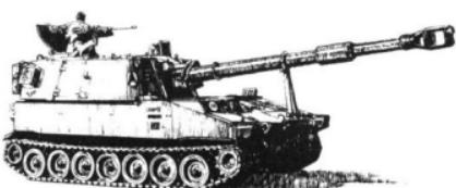
西側の国で最もスタンダードな自走砲で、1983年に生産が終了するまで、約2500両余りが生産され、アメリカ軍だけでなく世界各国で使用されている車両である。車体及び砲塔は防弾アルミの溶接構造で、スクリーンを張ることで浮航能力を使用することもできる。各国の砲の基準にもなっている車両なので、ずば抜けた性能を持っているわけではないが、非常に使いやすくてまとまった性能である。余裕があればMLRSとの併用をしたい車両である。
