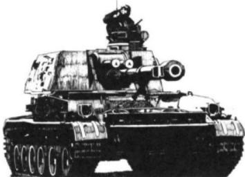
それまで地対地ミサイルや固定砲塔の自走砲を使用してきたソビエト軍が西側の旋回砲塔を初めて取り入れたのがこのM1973で、SA-4ガネフに使用された車体にD20-152mm加農砲を搭載している。防御率は高く設定しており、そのほかのデータはM109と同じである。ただし燃料の搭載量が少なく、遠方へ自力で進出させることは難しい。弾薬の補給も必要であることから、補給車と共に行動を共にすることになりそうである。
