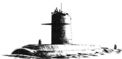
1970年代に建造されたアゴスタ級をベースに武装、ソナーなど内側に大きく手を加えた艦で、アメリカやイギリスの潜水艦と比べるとかなり小型の潜水艦である。対潜水艦装備としてL-5魚雷を、対水上艦装備としてSM39潜水艦発射型エグゼミサイルを搭載している。正式な名称はSNA72タイプといい、現在では生産終了、拡大型のアメティスト級の生産がスタートしている。ロスアンジェルスよりも耐久力がかなり低いので、1撃で沈められる可能性もある。
