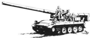
火力はM109とM110の丁度中間に位置する車両で、1980年までに約千両が生産されている。砲塔は使用されず、車体に直接60口径長砲身M113-175mm加農砲を搭載している。発射速度はM110よりも遅く、1発／分であるがゲームではいっさいおかまいなしで、砲はすべて発射カウントが40に統一されているので、同じ感覚で攻撃を組み立てることができる。M110が使える国では、攻撃率がより高いM110の生産をお奨めする。
