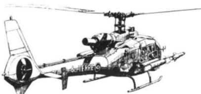
本機はエアロスパシアル社とウエストランド社とが共同開発した多用途ヘリである。速度の上昇を狙い、胴体後部やエンジン、後部ローターをフェアリングで覆い、機体全般を流線型にして空気抵抗を少なくしている。また、多用途ヘリとしてだけではなく、攻撃ヘリとしての装備も可能であり、胴体側面部にHOT対戦車ミサイルを4発搭載して、コクピット上部にそれの発射時に用いるSFIMジャイロ水平サイトを装備している。
