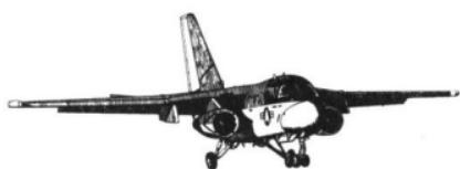
艦載型の対潜哨戒機である本機は、それまでS-2シリーズによって行われていた任務を後継するためにロッキード社によって1968年から開発が始められた。翼の折り畳み機構が左右翼で前後にずらして重ならない様になっているのがユニーク、かつ珍しい。通常MADブームは機体内に格納されている。その後空中給油型のKS-3や、多用途型のUS-3が派生している。US-3などは本国から空母への郵便配達などにまで使用されている。
