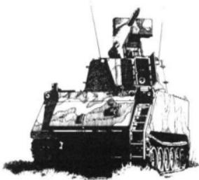
対潜ロケットで有名なボフォース社が開発した短SAMで、M113の車体にゴツイ砲塔が搭載され、その中にRBS-70対空ミサイルが7発、エリクソンHARD3次元レーダーとレーザー照射システムが内蔵されている。もともと短SAMというより中距離対空ミサイルなので攻撃率も航空機に対して強く、ヘリコプターについてはそれほどでもない。ベースがM113であることから防御率も高くはなく、足も非常に遅いのが最大の欠点である。
