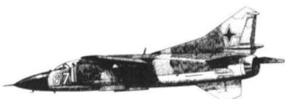
MiG-21の後継機として開発が始まったが、世界でも類を見ない、単発可変翼戦闘機である。MiGシリーズ共通の試練として、欠点克服のための改良の積み重ねが<sup>g</sup>、本機においても行われ、多くの派生型を生んだ。F-14と同様に、ミサイル母機としての性格が強<sup>g</sup>いが、本機は格闘戦闘を苦手とし、運動性能はかなり低いと思われる。そのため、ソ連軍内においても急速に数を減らしており、息の短い戦闘機であるといえよう。
