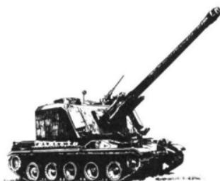
1977年から生産が開始されたフランスの自走砲で、AMX30主力戦車の車体に155mm砲を搭載している大型車両である。能力はアメリカのM109とほぼ同じで、携帯弾薬数が1発多い程度である。ロケット砲を持たないフランスにとって最も有効な長距離支援火力である。フランスの他サウジアラビアや、話題となっているイラクの精銳部隊がごく小数使用している。
