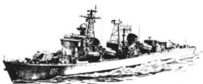
1950年代に登場したソビエトのコトリン級駆逐艦のコピーであるが、船体中央にHY-2 (CSS-N-2) 対艦ミサイル3連装ランチャーを2基装備している。広域防空ミサイル、近距離対空ミサイルのいずれも搭載しておらず、基本的には対潜艦であるらしい。イギリスの技術供与でシーダートSAMの供与が予定されていたが、天安門事件により話がご破算になったようで、未だ装備されたとの話は聞かない。
