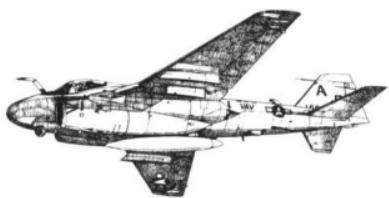
米海軍や米海兵隊において運用されていた艦上攻撃機で、全天候性能をもち、超低空侵入を得意とする。大変多くの装備を搭載することが可能で、攻撃機としては非常に高い性能を持っていた。しかし、最近ではF-18にその任務をゆずりはじめ、あまりお目にかかることはなくなった。現在ではその運用性の高さから空中給油機や電子妨害機としての改造を受け、まだまだ活躍している。オタマジャクシに羽を付けたような形態が面白い。
