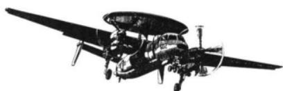
米海軍や、航空自衛隊でも使用しているので我が国の空でもよく目につく機体である。本機も機体上面に大型レーダーを搭載して重そうに飛んでいるので、かなり特徴的な形態をしている。本機は、元々 C-2A グレイハウンドを母機として改修を受け、早期警戒機として E-2A と生まれ変わった物であり、これが機首、胴体上部冷却用インテイクなどが改修されて E-2C となった。イスラエル空軍でも、実戦を経験している。
