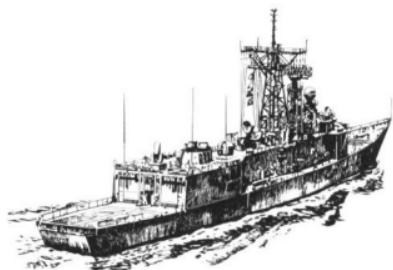
ノックス級フリゲート艦の後継として開発されたガスター・ピング推進のフリゲート艦であるが、ノックス級が対潜艦であったにもかかわらず、後継艦は汎用艦である。広域防空ミサイルスタンダードSM1MR、ハーブーン対艦ミサイルを装備している。当然対潜兵器も装備しており何でも屋の性格が強い。ただし耐久力が低く、最悪の場合、対艦ミサイル1発で沈んでしまう可能性があるので、運用するときにはこまめに修理してやることが必要である。
