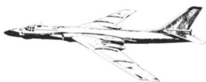
800機以上が生産された本機は、1952年に初飛行している。本機に搭載されているエンジンは、当時のソビエトのテクノロジーの粋を集めたターボジェットエンジンで、これのおかげで当時のVボーマーシリーズが4発、米国のB-47が6発もエンジンを搭載していたのに、2発のエンジンで航行する事が可能だった。現在ではミサイル母機、ECM機などに改造されている。しかし、時代の流れには勝てず、新鋭機に取って代わられようとしている。
