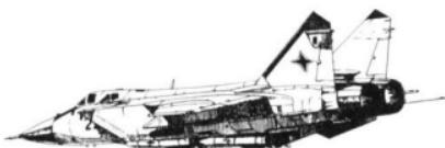
本機は、素人目には複座型のMiG-25とほとんど区別がつかないかも知れないが、実際はかなり性能が向上している。これは、米空軍の戦略爆撃機B-1を要撃するために改良が行われたことによる。電子装備の強化が主な改良点で、ルックダウン性能を増し、超低空を高速で進入してくるB-1を要撃するためだけに特化している。しかし、MiG-25の時と同様に、早くもB-1よりもB-2が主任務に就こうかとしているのが哀れである。
