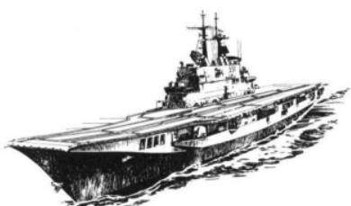
憲法上の制約から固定翼空母を持つことが許されなかったイタリアのヘリコプター母艦であるが、ようやく憲法が改正され、正式にハリアー母艦として活動できるようになった。甲板前方にはインヴィンシブル同様の傾斜を持っており、当初からハリアーを運用できるように設計されている。インヴィンシブルと異なり、対空ミサイルの他、オトマット対艦ミサイルやA244S魚雷も装備して、旗艦的な役割も持っている。オリジナル生産タイプを編集する際にはぜひ加えておきたい艦だ。
