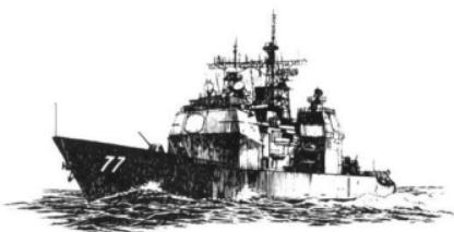
発達が著しい対艦ミサイルや航空機からの脅威に対抗して開発されたイージスシステムを搭載した巡洋艦で、船体はスブルアンス級駆逐艦のものを流用している。イージスシステムの中核になるのが、SPY1Aフェイズドアレイレーダーで200以上の目標をリアルタイムに追尾することができる。搭載している艦対空ミサイルスタンダードSM2 MRの搭載弾数が4射撃分(1射撃15発)しかないために、連続攻撃を受けるとすぐに弾切れになってしまうのが欠点だ。
