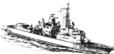
この艦は対潜駆逐艦であるTYPE70(A/S)の防空型で、フォッシュ、クレマンソー、そして現在計画が進行中の新型原子力空母シャルルドゴールといったフランスの空母護衛用に開発された駆逐艦である。シャルルドゴールにも搭載が予定されているミストラルSAMを装備しているが、同時発射数6と多いことからか、2射撃分しか弾薬を搭載していない。他にもエグゼミサイルや魚雷も装備し、機動部隊の何でも屋になる運命である。
