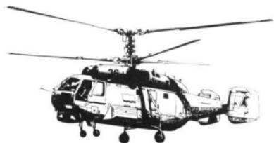
Ka-25ホーモンから発達した本機は、ホーモンの欠点を是正し、エンジン出力と行動半径を2倍にし、胴体を大型化させた物である。ホーモンにせよヘリックスにせよ対潜戦闘用はA型であり、B型は水上戦支援用である。1981年9月に初めて発見され、急速にホーモンとの交代がされているようである。電子装備もかなり発達しているようだ。2重反転ロータなど、最近ではあまり見られない形態をしている。
