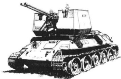
ソビエトからZSUシリーズの自走対空砲の供与を受けることができなかった中国が、独自に開発した車両である。その内容は、第二次世界大戦で活躍したT-34中戦車の上に37mm対空機関砲を搭載した簡単なもので、砲塔に天井がないオープントップ型である。ゲーム中でも古さを拭うことはできず、攻撃率、防御率の両面で最下位を独占している。悲しいことに航空機への攻撃率はわずか5%で、存在の必要性を感じなくなってしまうのである。
