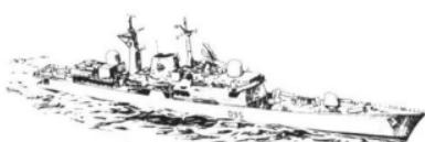
あのフォークランド紛争でエグゼミサイルの餌食となり撃沈されたシェフィールドの改良型で、正式分類タイプ42バッチャ3（タイプ42C）と呼ばれる。艦首が延長され居住性が良くなつたほか、シーダート中射程艦対空ミサイルの搭載弾数も増えている。対艦ミサイルなどの対艦装備は一切なく、114mm砲も同時発射数1発と情けないので、陸上攻撃にも使用することはできない。そうなると残るは防空任務だけであり多目的には使えない艦である。
