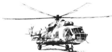
Mi-8を近代化させるために、Mi-14ヘイズ対潜哨戒ヘリのエンジンに換装、出力の強化をした。基本的な機体構造は、Mi-8のものであるが、近代化改造によりかなりの点で改良がなされた。また、固定武装を前方固定式の機関銃だけに絞ったことにより、多用途ヘリから人員輸送ヘリの色が濃くなっている。しかし、ソビエト軍内でもこの機体は少なくなりつつあり、順次、より大型のMi-26が多くなってきていている。
