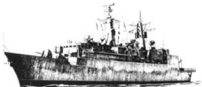
タイプ22はイギリスの主力汎用フリゲート艦で、装備が異なる3タイプがあるが、今回登場するのは後期型であるバッチ3である。アメリカのペリー級同様、装備はバランスがとれしており、特に対潜魚雷であるスティングレイは最高の攻撃率を持っている。耐久力も高く安心して使える艦である。短距離SAMもシーウルフも搭載しており、1射撃で6発の同時射撃を行なうが、2射撃分の弾薬しか持っていないので長い間展開させておくことはできない。
