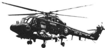
ウエストランド社とエアロスパシアル社との共同開発によって誕生した中型汎用ヘリである。しかし、汎用ヘリとしてはかなり卓越した能力をもつ。イギリス陸軍が採用しているのが、リンクスの陸上型であり、TOWミサイルを搭載して、チエインマウントサイトを用いて対戦車攻撃や、兵員輸送、ロケット弾による対地攻撃なども行える。対艦装備を施されてイギリス海軍などで用いられているのが海上型である。
