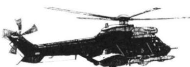
エアロスピバシアル SA.330ピューマをフランス陸軍の要求により改良発達させた機体である。変更点は、機首部、メインローター、テイルローター、機首のレーダー装備、エンジン強化、テイルブーム、エアーアインテイクの妨塵フィルターの装備などである。基本構造としては、ピューマのものを流用しているが、かなり高性能な機体にベースアップした。人員輸送用であるSA.332Cは、20人を一度に輸送できる。
