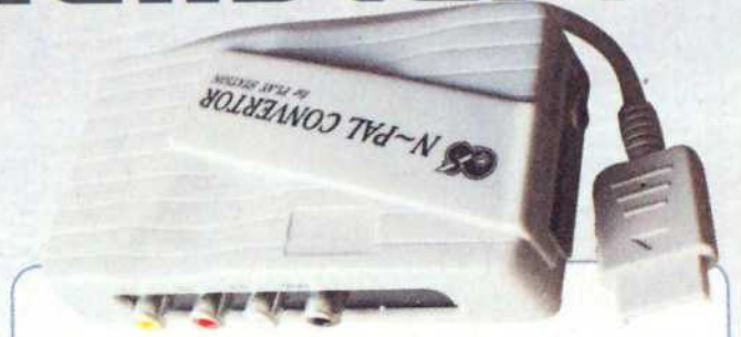
Die Notlösung: Mit einem NTSC/PAL-Konverter (80 Mark) stöpselt Ihr die Playstation 2 an die Cinch-Buchsen Eures Fernsehers.
