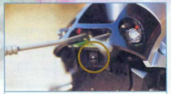
Zwischen den Fühlern besitzt der Wonderborg einen Lichtsensor – der schwarze Punkt in der Mitte.
