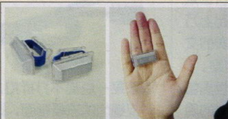
▲龙手控制器的表面能够反射红外线，将信号传给体感器。安装在中指和无名指后的这是这个样子的。
