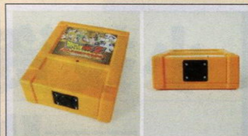
▲体感器是一个长约12cm、宽约10cm的长方形盒子。在前端安装了红外线镜头。体感器就是从这里接收玩家的动作信号的。
