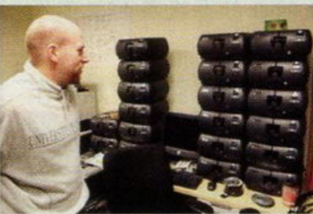
▲Xbox在发给零售商前要抽取样品在这里进行极限状态的质量测试。
