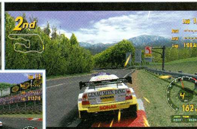
"GT3" bietet einen anamorphen 16:9-Modus. Auf normalen Fernsehern seht Ihr ein gequetschtes Bild (links). Oben die korrekte Version mit aktivierter Umschaltung.
