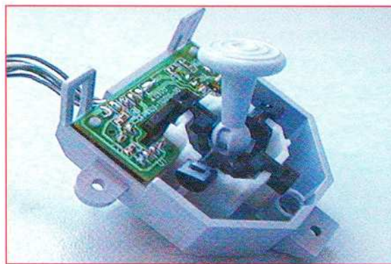
Das Herz Eures Nintendo 64-Analogsticks: Über Plastikbrücken und Zahnräder werden Eure Kommandos registriert.
