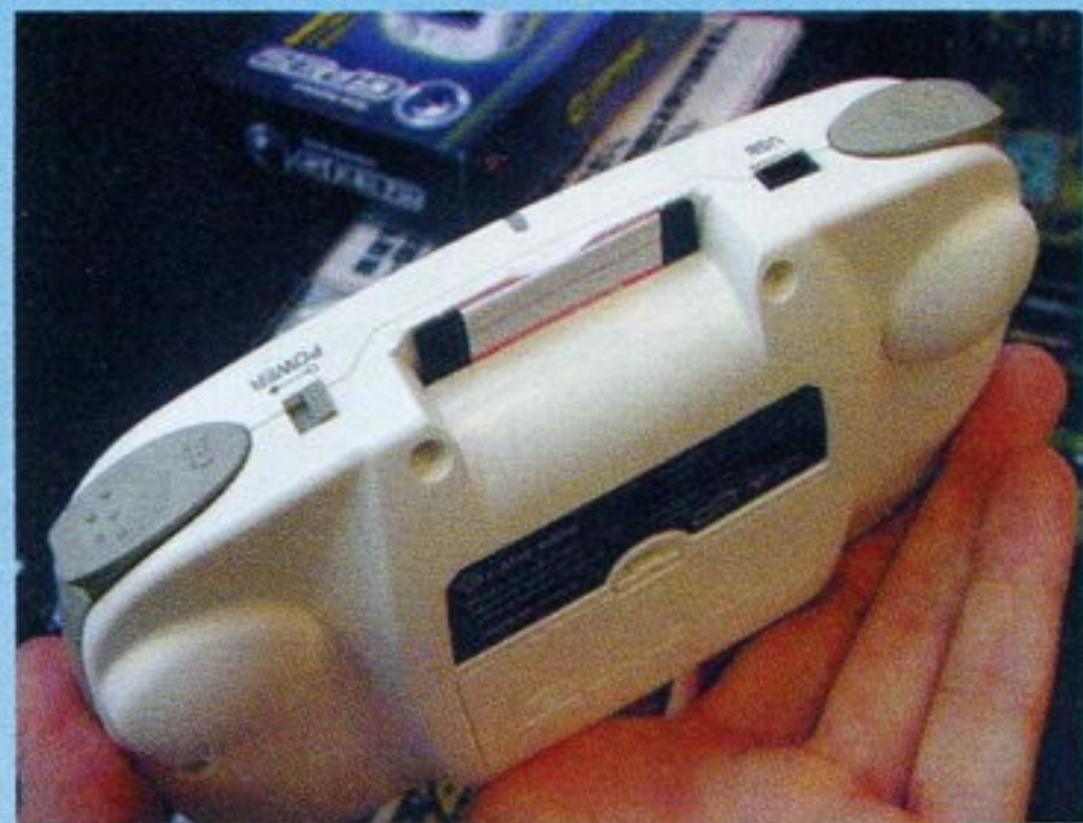
大家可以看到,插在主机内的SMC卡相当薄。卡上面没有图案,应该是空白卡。
