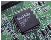
Silicon Image Si1164CT64 DVI 的轉碼晶片。
