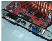
提供 15Pin D-sub、DVI-I 與 S 端子輸出。
