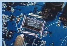
DVI-I 轉碼功能，則由 Silicon Image 的 S11164CT64 DVI 轉碼晶片來控制。
