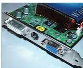
提供15Pin D-Sub、DVI-I與S端子輸出
