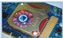
顯示晶片上的散熱片並未與記憶體為一體。
