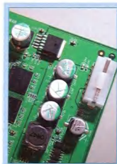
需要外接 4Pin 電源，週邊的電容配置相當紮實
