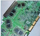
背面亦焊接 8 顆 DDR 記憶體，共提供 256MB 顯示記憶體。
