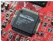
Silicon Image Si1164CT64 DVI 的轉碼晶片。
