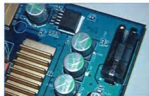
青雲 GeForce FX5900XTV 需要外接一組大的 4Pin 電源輸入。
